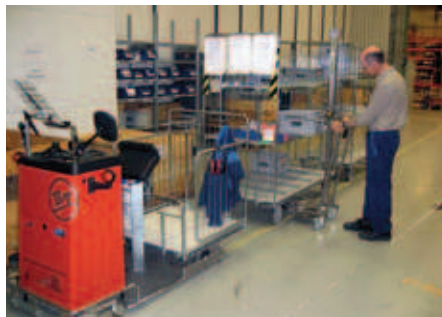
Mjölkrundeleverans till monteringen. På mjölk-rundan sker leverans av material och komponenter till monteringen.
