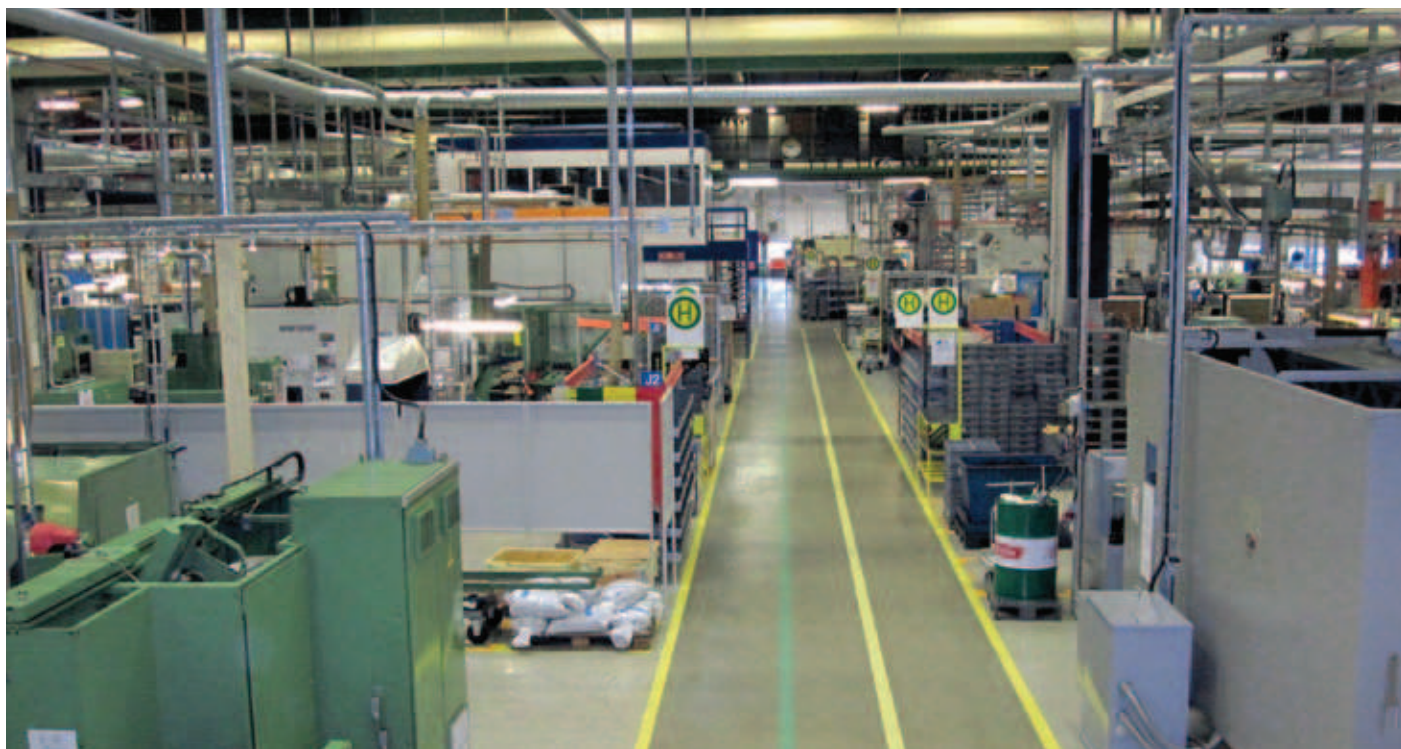
I stort sett alla pallar är borta i monteringen. Man flyttar lådor i stället. Det går ”mjölktåg” i stället för truckar. Mjölkrundorna sker vissa klockslag, tågen stannar vid bestämda hållplatser och flyttar material mellan olika operationer.
